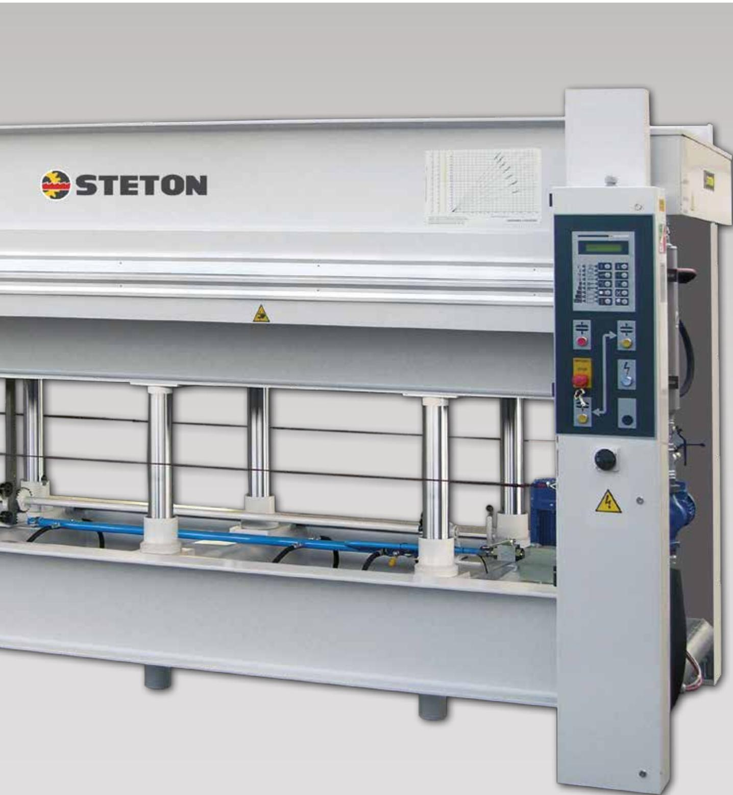
**Nella foto:** P 120 con boiler elettrico ad olio e programmatore elettronico (opzionale)
