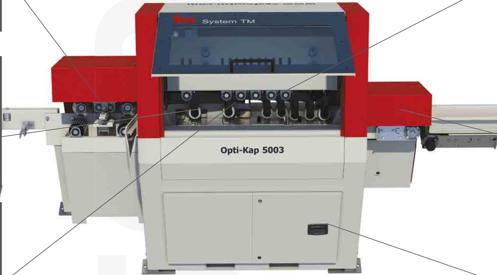
► Integrierte, doppelte obere und untere Walzen für einen genauen Vorschub der Werkstücke.
