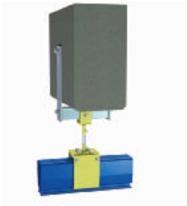
1. Träger für Betonschienen hält das 4-kant Stahlrohr, welches Unterstützungspunkt für die U-Aufhängung ist.
