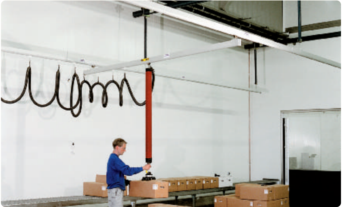
LR-System aus Aluminium, Ende der Verpackungslinie, Lebensmittelindustrie.
