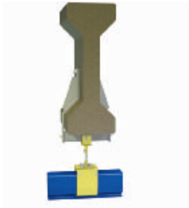
2. Beispiel einer Aufhängung für gebogene Betonträger. Der Ausleger unterstützt das Stahlrohr an welches eine U-Aufhängung angebracht ist.
