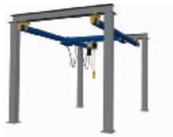
LR120/170 Stahlprofile in einem Niedrigbausystem. SWL bis zu 1.500kg mit verstärkten Profilen. Die freistehende Portal-Befestigungsstruktur ist eine Alternative zur Decken- und Wandaufhängung.
