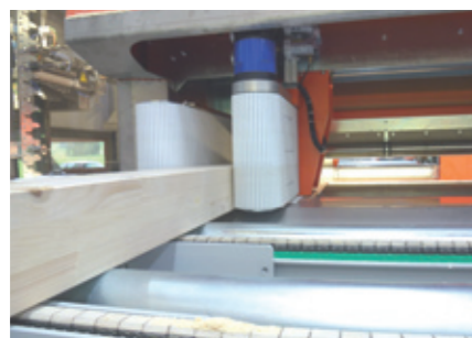
Riemenbatterie zur Bauteilförderung courroies de transport transfer to hauling battery
