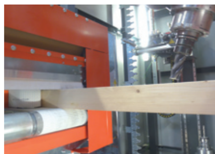
allseitige, exakte Bauteilführung guidage optimal des pièces sur quatre faces exact component guidance
