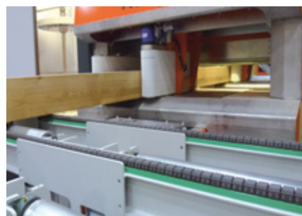
Beschickung mit Vereinzelfunktion approvisionnement avec fonctions distinctes charging with separating function
