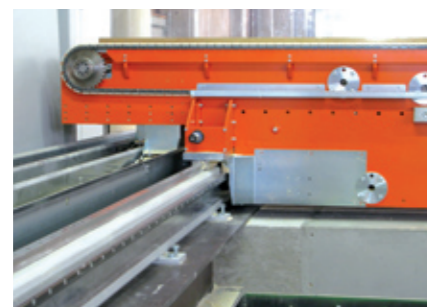
Bauteilförderung via Portalwagen convoyage des pièces au moyen du chariot component transport via portal carriage
