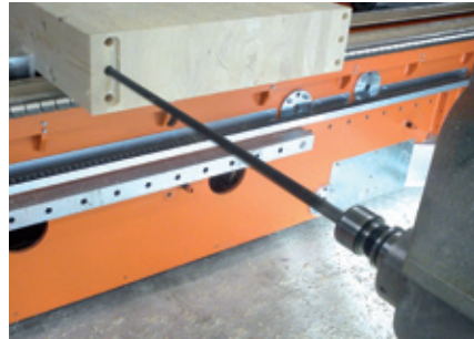
5-Achs-Bohrungen bis 1.5 m agrégat perçage 5 axes max. 1.5 m 5-axes holes up to 1.5 m
