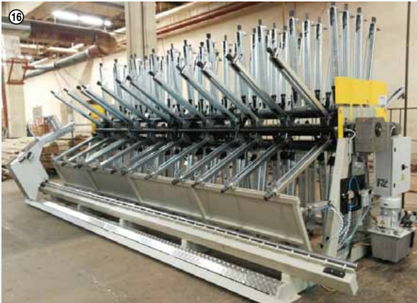
①⑦ Verleimstern Typ SLA – H - automatische Clamp carrier type SLA – H - automatic Encolleuse en étoile type SLA – H – automatique Strettoio incollaggio listelli tipo SLA – H – automatico Estrella Encoladore de tablas Tipo SLA – H – automático Тиски для склеивания по ширине, тип SLA – H, автоматические
