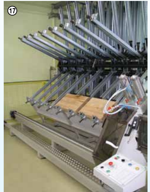
①⑦ Verleimstern Typ SLA – H - automatische Clamp carrier type SLA – H - automatic Encolleuse en étoile type SLA – H – automatique Strettoio incollaggio listelli tipo SLA – H – automatico Estrella Encoladore de tablas Tipo SLA – H – automático Тиски для склеивания по ширине, тип SLA – H, автоматические
