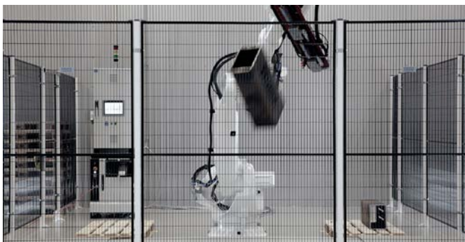
Ein Stabilitätstest mit einem ABB-Roboter ist mit einem Magnetgreifer vorzunehmen, der ein Stahlrohr von 52 kg in den Maschinenschutz Smart Fix schleudert.
