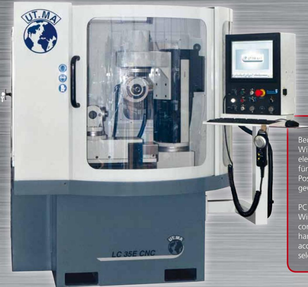
Bedienpaneel mit PC und Windows Software und elektronisches Handrad für die hoch-präzision Positionierung der gewählten Achse.
