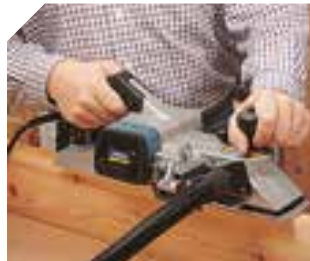
Absaugstutzen zum Anschluss einer externen Absaugvorrichtung.
