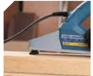
Parkschuh zum Abstellen des Hobels, damit Oberfläche oder Hobelmesser nicht beschädigt werden.
