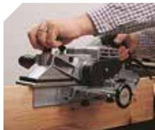
Verstellbarer Anschlag für verschiedene Fasen und Fasenwinkel.
