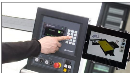
MAGIS zeigt dem Bediener an, an welchem Anschlag das Maß eingestellt wird.
