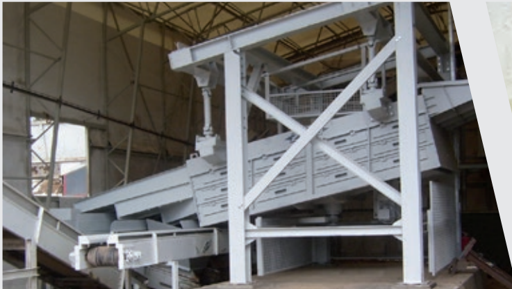
Plansichter zur Korngrößenklassifizierung von aufbereitetem Altholz
