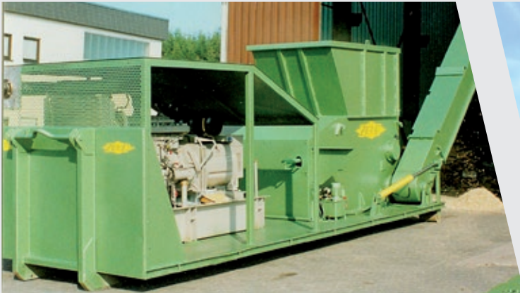
Mobiler ZTLL mit Aggregat und Trogkettenförderer
