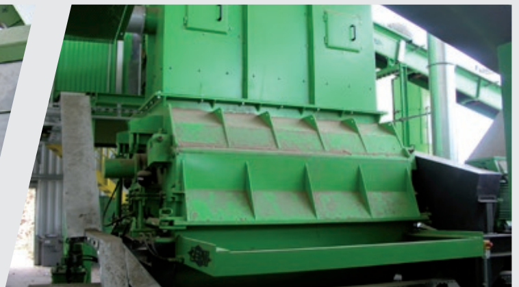
Hammermühle für die Nachzerkleinerung
