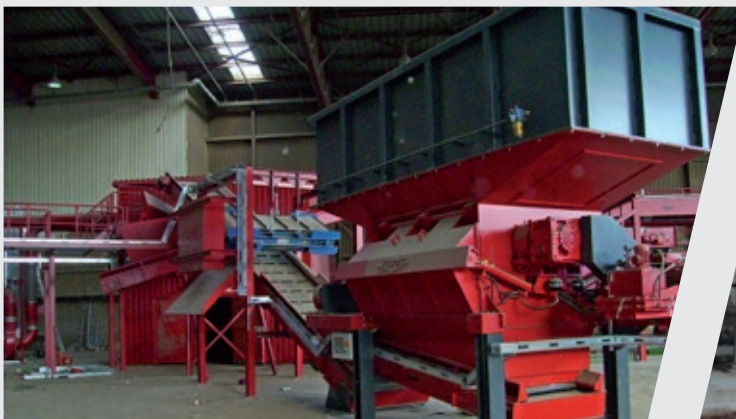
Vor- und Nachzerkleinerung mit Metallabscheidung
