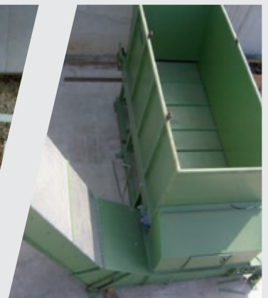
Kettendosierbunker mit TKF
