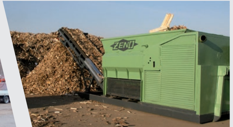
Mobiler Vorbereiter mit Diesellaggregat
