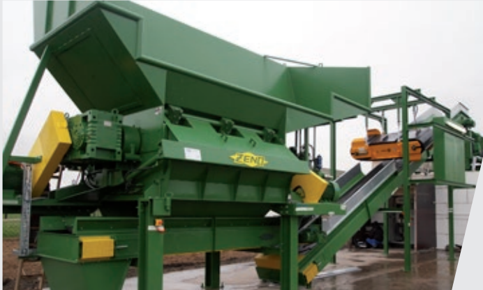
Vorbereiter für Alt- und Frischholz mit Austrag und Überbandmagnet
