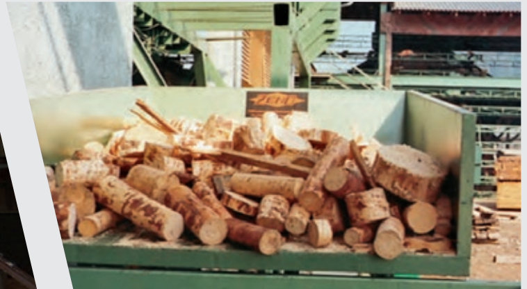
ZENO-Vibrations-Dosierförderer mit Vibrationsrinne in einem Sägewerk
