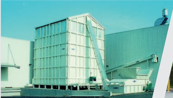
ZENO-Anlage mit Zerkleinerer Typ ZTLL und Aufgabetrichter. Förderung des Hackgutes über Trogkettenförderer ins Silo mit 1.000 m³
