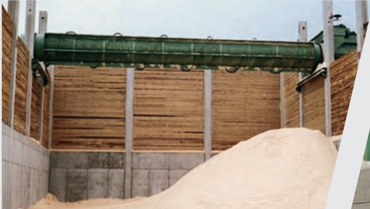
ZENO-Trommelsieb zum Absieben von Sägemehl in einem Sägewerk
