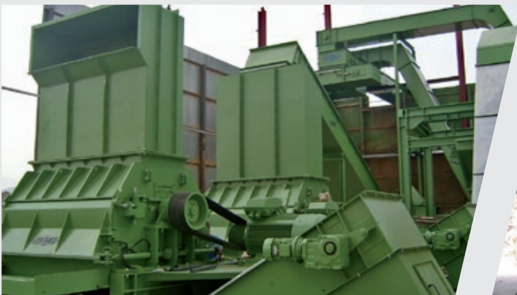
ZENO-Nachzerkleinerer Typ ZHM, Beschickung und Abtransport über Trogkettenförderer
