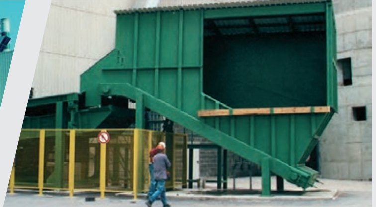
ZENO-Aufgabebunker mit Siebanlage für eine Ersatzbrennstoffaufbereitungsanlage „Holz“ in einem Zementwerk
