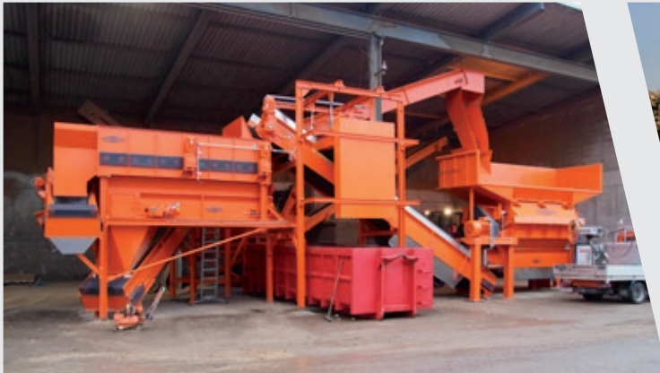
Altholzaufbereitungsanlage in einem Schritt auf 60 – 80 mm Korngröße
