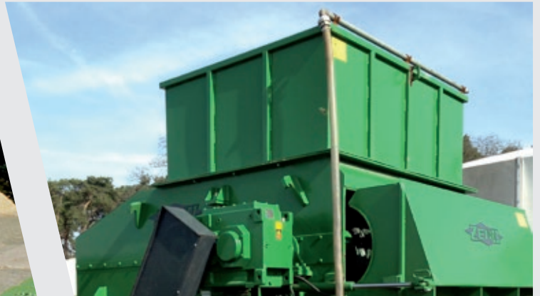
ZTLL für Nachzerkleinerung von Altholz mit Wasserbedüsung
