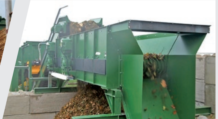
Scheibensieb zur Korngrößenklassifizierung von Alt- und Frischholz
