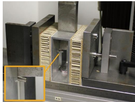
Abb. 3: Bodenträger-Prüfvorrichtung für Sandwichplatten
