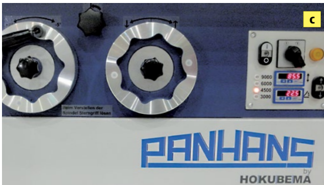
Elektromotorische Höhenverstellung der Frässpindel
