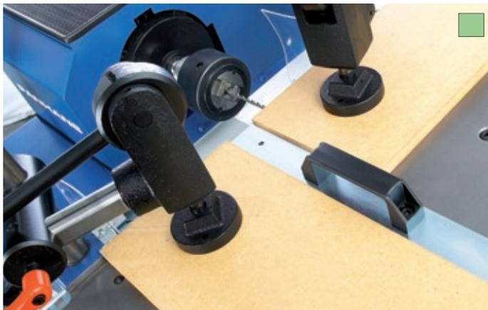
Steckbarer Rahmenanschlag mit 2 Stück Handexzenterpanner
