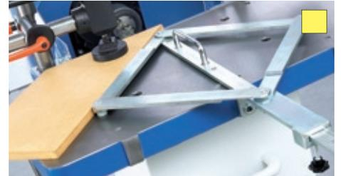
Doppelwinkelverstellanschlag, stufenlos einstellbar 22,5 - 75°
