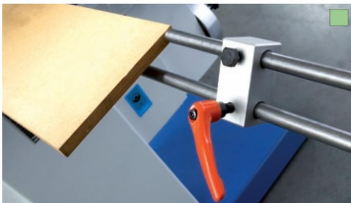
Werkstückanschlag bis 1500 mm lang, stufenlos einstellbar
