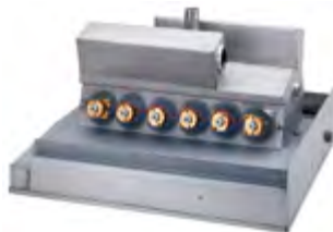
Foulardbecken zur Beschallung von Farbflotten
