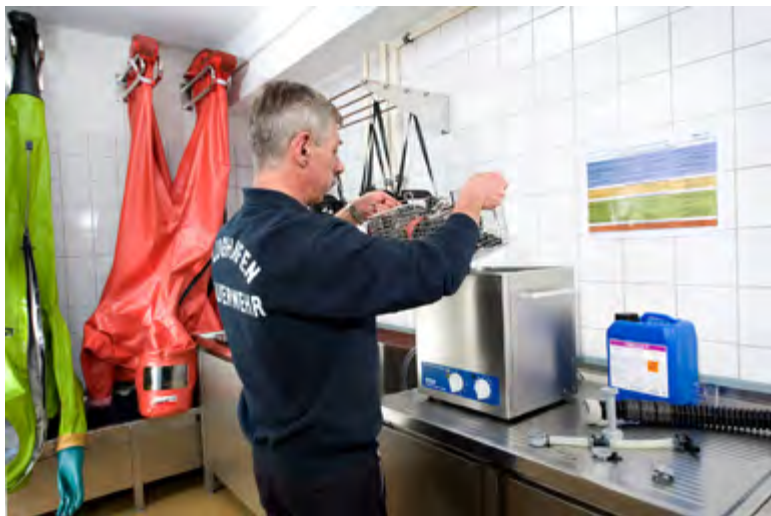
Reinigung von Atemschutzmasken in einer Feuerwehr
