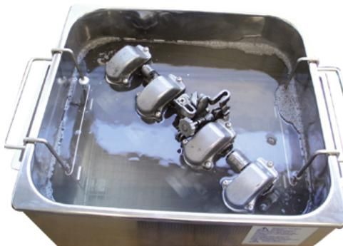
Vergaserreinigung im Ultraschallbad
