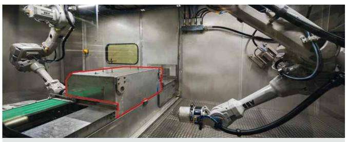
Werkstückträger-Reinigung als optionale Komponente
