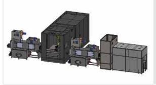
Automatisierte Prozesskette von Vorreinigung, HD-Entgratung, Feinreinigung, Vakuumtrocknung und Kühlung
