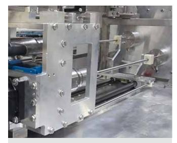
Hochdrucklanzen gezieltes Entgraten von Öl- und Wasserkanalbohrungen
