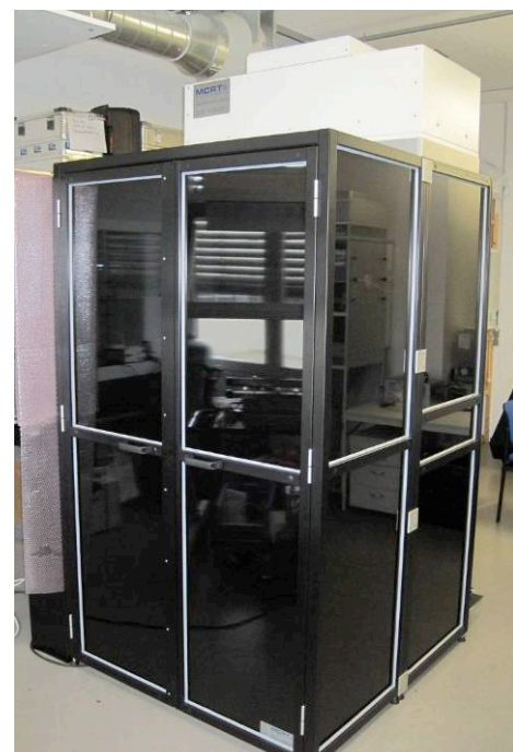
Außenansicht der Dunkelkammer, links die Türen zum Betreten, oben auf die FFU
