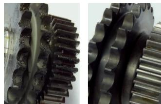
Abreinigen von Öl und Spänen
