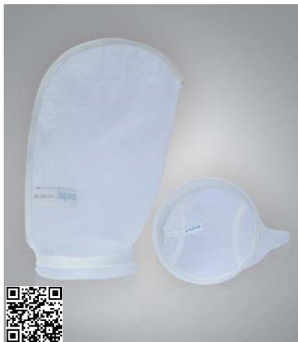
Die monofilen Filterbeutel *acuraBag*® werden aus textilem Nylon Quadratmaschengewebe in verschiedenen Feinheitsgraden gefertigt. Die obere Abdichtung erfolgt über ein angeschweisstes Kunststoff-Formteil, dessen Dichtlippe eine bypassfreie Abdichtung garantieren. Diese Filter finden als Oberflächenfilter ihre Anwendung hauptsächlich in der Vorfiltration zur Rückhaltung von groben Partikeln. Auch Auswaschen und Wiederverwendung ist gängige Praxis bei diesen Filterbeuteln.
