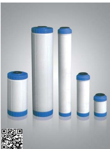
*apuraRefill* befüllbare Filterkerzen dienen zur Aufnahme von Harzen, granulierter Aktivkohle und anderen Ad- und Absorptionen. Das zu filtrierende Medium tritt von unten in die Filterkerze und durchströmt den Filterbehälter axial. Dadurch wird eine größtmögliche Kontaktzeit mit dem Füllmedium erreicht. Die Füllung wird durch eine Schaumstoffeinlage in ihrer Lage fixiert. Dies verhindert wirkungsvoll eine Bypassbildung. Ein integrierter 20 µm Nachfilter verhindert ein Austreten von Teilchen.
