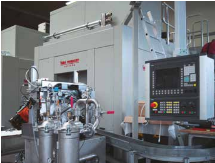
HC flex mit Werkstückzuführung und Vorreinigungsstation
