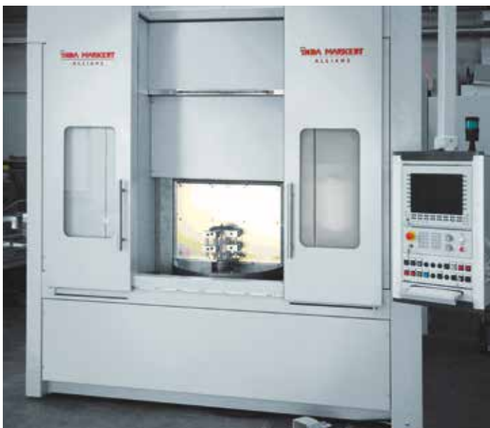
HC flex mit Werkstückzuführung und Vorreinigungsstation
