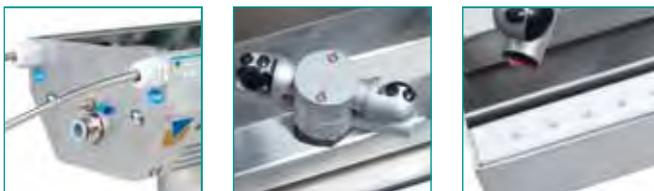
Unterseitenreinigung (z.B. Kunststoffschalen) mit ionisierter Luft und Rotationsdüsen bei gleichzeitiger Absaugung ➔
