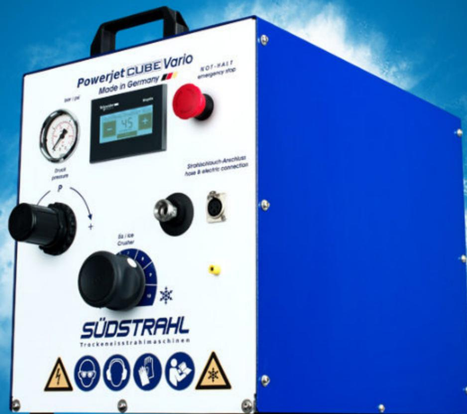
Die CUBE Vario. Ein High End Trockeneisstrahlgerät in der bekannten, kompakten CUBE Baugröße. Gesteuert über einen 3,4" Touch-Display. Einstellbares mechanisches Eis-Mahlwerk. Für feine Arbeiten ab 0,1 mm Korngröße bis zu groben Arbeiten mit 3,0 mm Eis-Körnung und bis zu 40 kg/h Eismenge.
