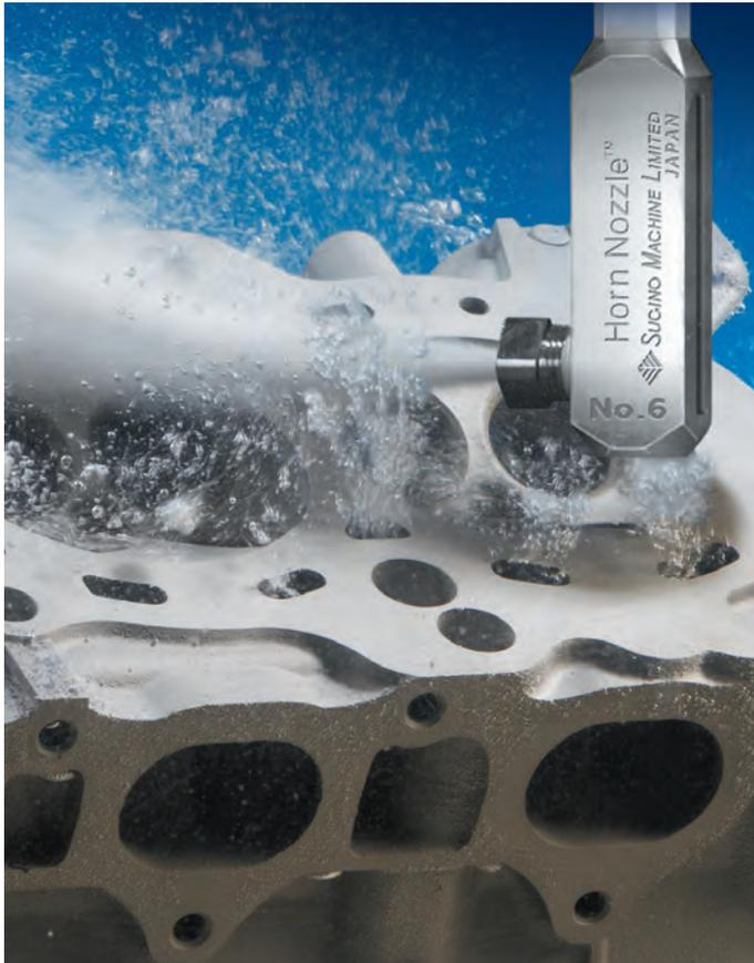
Durch das Zusammenspiel des HD-Wasserstrahles von 70 bar und der Kavitation wird eine effiziente und sehr effektive Schmutzablösung aus dem Inneren von komplexen Werkstücken erreicht.
