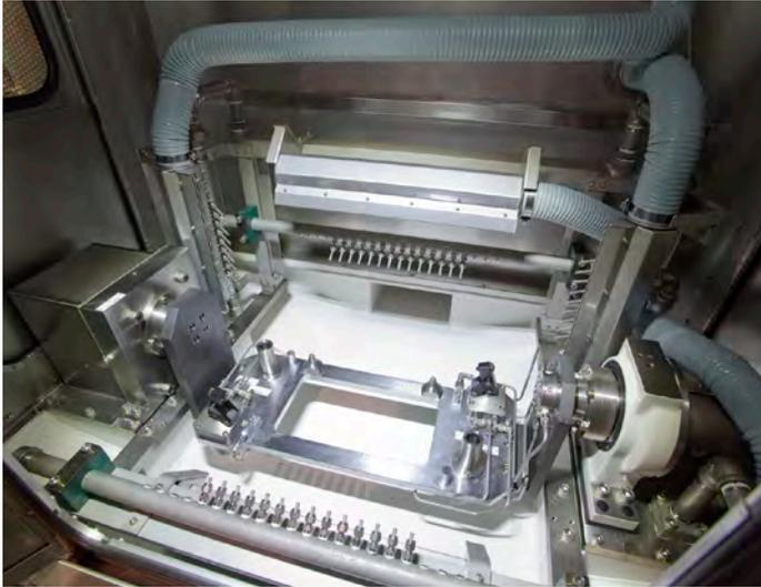
Kombination aus der Drehbewegung eines 4-Achsen Tisches mit einer Vielzahl an Düsen mit einer Ausrichtung in 3 Richtungen, um die Teile effizient zu trocknen.
