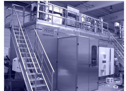
Die kompakte Konstruktion der Anlage ermöglicht ein Aufstellen auf sehr geringer Grundfläche. Ein Grossteil der Peripherie ist auf die Maschine gesetzt, so dass sich eine zweistöckige Bauweise ergibt.
