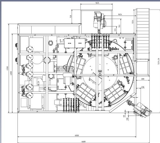
Diese Maschine wurde zur Reinigung von Getriebegehäusen konstruiert. Auf einem Rundschanttisch sind die Stationen Niederdruckreinigen, Hochdruckreinigen, Spülen, Vakuumtrocknen und Trockenblasen angebracht. Be- und Entladen des Werkstücks erfolgt automatisch durch einen Roboter, der Transport innerhalb der Anlage erfolgt taktend.
