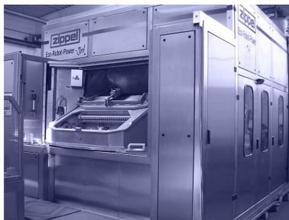
Um den Rundschalttisch herum befinden sich zwei Laugenbehälter. Das Reinigen und Spülen der Waschteile wird jeweils über eine Kreiselpumpe durchgeführt. Das Hochdruckreinigen erfolgt durch eine Vollstrahldüse, die an einem Roboterarm befestigt ist und von einer Hochdruckpumpe versorgt wird. Die gesamten Abwässer der Anlage werden gefiltert dem Kreislauf wieder zugeführt.
