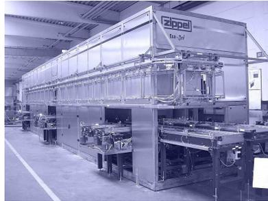
Dieses Beispiel für eine Durchlauf-Reinigungsanlage mit integrierter Fördertechnik besteht aus den Stationen: Reinigen, Abblasen, Spülen, Vakuumtrocknen sowie Kühlen. Unter dem Transportband befinden sich 2 Laugenbehälter mit einem Fassungsvermögen von je 2000 Litern.
