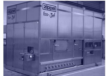
Am Einlauf ist eine Schwadentrocknung angebracht, die verhindert, dass an den Ein- und Ausläufen ein übermäßiger Dampfaustritt stattfindet. Seitlich an der Maschine befinden sich Wartungstüren, welche einen optimalen Zugang zu den Düsen bzw. den Blasfächern ermöglichen.
