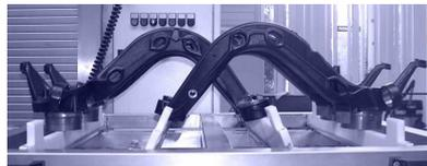
Mit Hilfe einer Pumpe wird die Waschflüssigkeit über die in der Kabine oben und unten angebrachten Spritzkreuze und Düsen mit Druck auf die Werkstücke gespritzt. Die verwendete Reinigungsflüssigkeit wird gefiltert in Auffangbehälter geleitet und geht in den Kreislauf zurück. Reinigungskabine und Behälter sind in Edelstahl rostfrei ausgeführt und zur Wärmedämmung allseitig isoliert.
