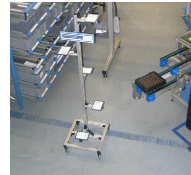
Partikelfallenständer zur systematischen Überwachung an verschiedenen Hallenstandorten und verschiedenen Höhenpositionen
