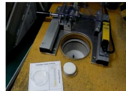
Partikelfalle am Montagewerkzeug
