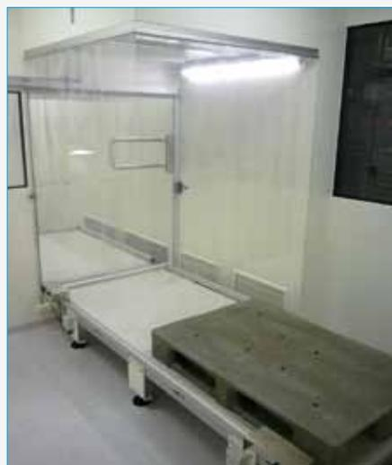
Probenzugkabine mit Laminaflow und Fördertechnik
