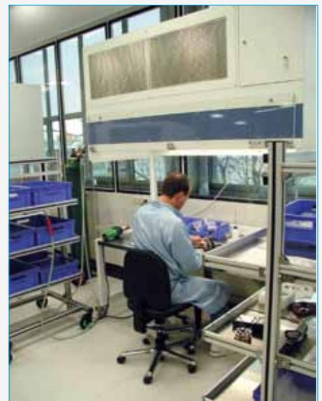
Präzisionsmontage unter dem Laminaflow
