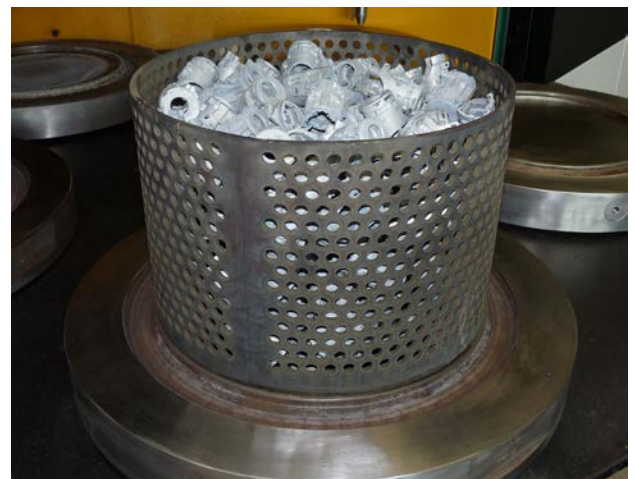
Bestückung der Entgratanlage iTEM400 Korb mit Schüttgut für Entgratkammer \varnothing 400 \times 300 mm
