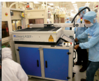
Sonderanlage „mould WIPER“ zur Reinigung empfindlicher Formen in der Halbleiterindustrie
