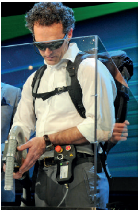
Backpack-Laser im Einsatz – frei von Versorgungsleitungen, mit fasergekoppelter Bearbeitungsoptik, integrierter Steuer- und Kühleinheit
