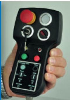
Praktische Fern- bedienung für den Rucksack-Laser
