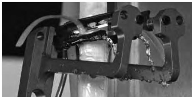
HART-COAT®-GLATT beschichteter (25 µm) Hebel und Messerträger für Spargelschälautomaten. Die Schicht schützt hier vor Korrosion und bietet verbesserte Reinigungs- und Verschleiß-eigenschaften.
