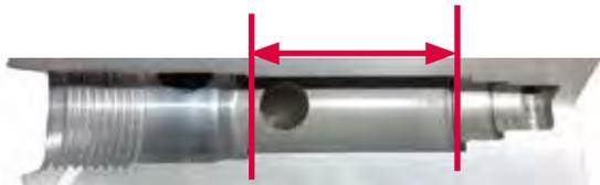
1/ Pumpengehäuse (Ausschnitt): rot markiert den Bereich, der mit SELGA-COAT® beschichtet wird.
