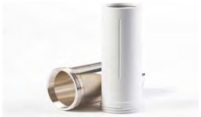
Magnesium-Bauteil: links ohne, rechts mit MAGOXID-COAT®-Beschichtung.
