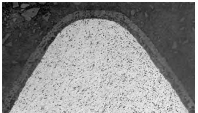
Die Aufnahme zeigt einen metallografischen Schliff der KEPLA-COAT®-Schicht an einem Gewindekamm.
