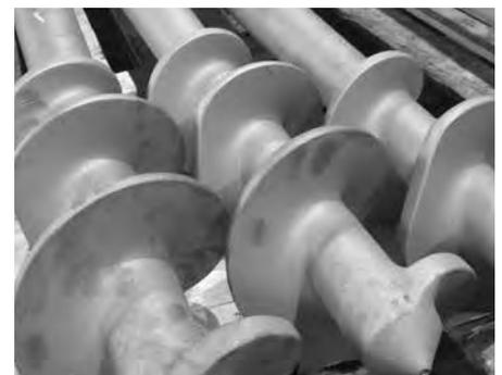
Verschleißschutz von Förderschnecken durch Flammspritzen und Einschmelzen einer Nickelhartlegierung.
