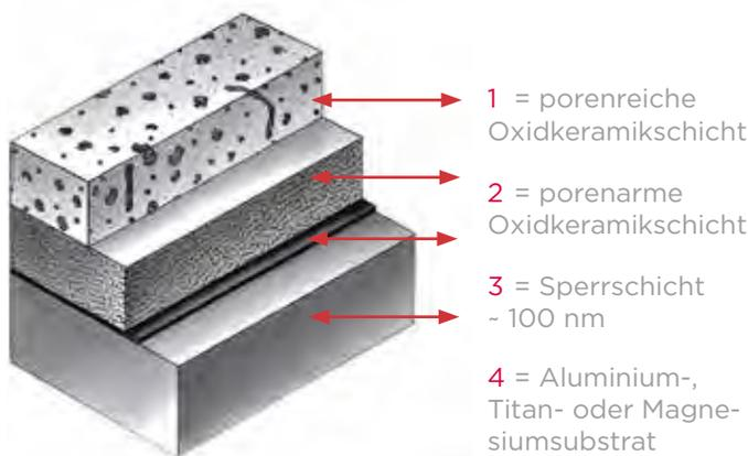
Die Schemazeichnung verdeutlicht den Oxidkeramik-Metall-Verbund beim MAGOXID-COAT®- bzw. KEPLA-COAT®-Verfahren.
