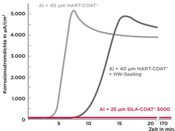
Verbesserung der Alkalibeständigkeit im Vergleich zu HART-COAT®-Schichten. Über das chrono-amperometrische Verfahren (Messung beim Ruhepotential) wird festgestellt, nach welcher Zeit ein Korrosionsangriff startet. Im vorliegenden Fall wurde die Messung in einer wässrigen 3-prozentigen Natronlauge durchgeführt.
