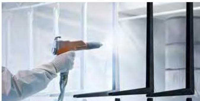
Pulverbeschichtung: Auftragen von Pulverlack in der Spritzkabine.
