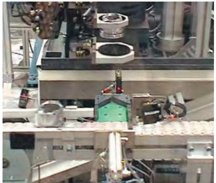
2/ Automatische Anlage zur selektiven Hartanodisation der ersten Ringnut von Motorkolben; die Arbeitsvorgänge sind Anodisieren, Spülen und Trocknen; die Taktzeit der Anlage beträgt 12,5 s pro Kolben.
