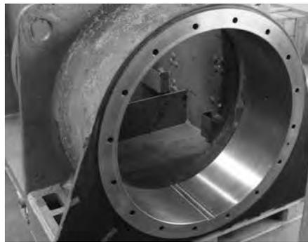
Instandsetzung der Lagerbohrung eines Stehagers durch Flammspritzen mit Chrom-Nickel-Stahl.
