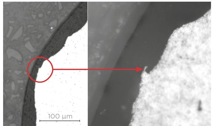
Querschliffaufnahme von EN AW-6060 (AlMgSi) mit SILA-COAT® 5000.
