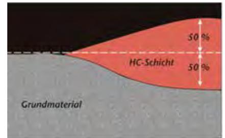
Schematische Darstellung einer 50 µm dicken HART-COAT®-Schicht (HC-Schicht) auf einem Aluminium-Grundwerkstoff. Diese durch Konversion gebildete Schicht wächst zu 50 % in das Material hinein und zu 50 % aus dem Material heraus. Die Schichtvariante HART-COAT®-GLATT (HC-GL) wächst dagegen zu 2/3 nach innen und 1/3 nach außen.
