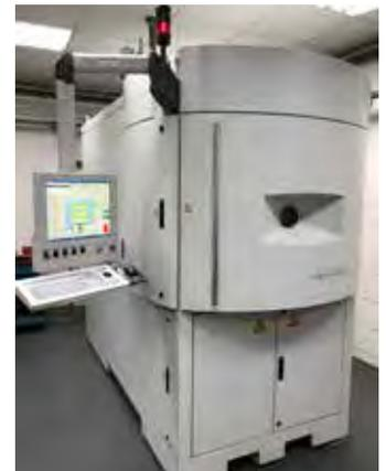
PVD-Anlage mit Duplex-Einheit (Nutzvolumen D 400 x 500 mm).
