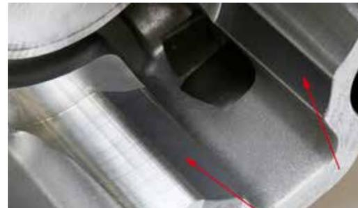
Aluminiumbauteil mit partiell beschichteten Flächen
