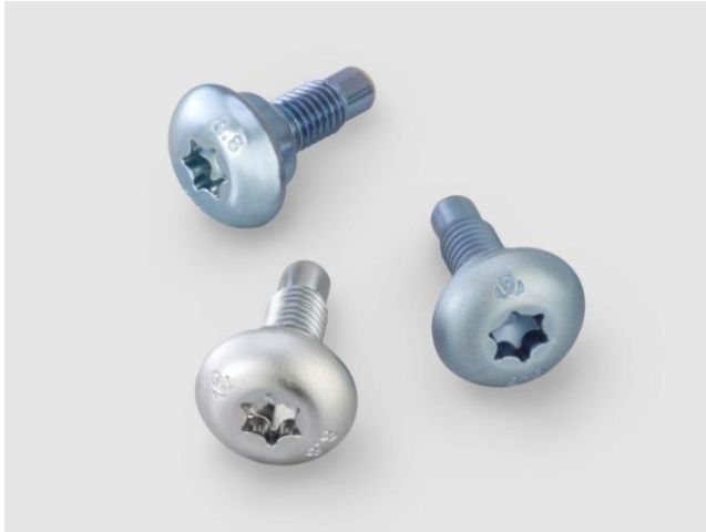
Abb. 1: Schrauben, beschichtet mit sauer ZnNi / Tridur® DB (oben), alkalisch ZnNi / Tridur® DB (rechts) und sauer Zink ZnNi / Tridur® DB / Sealer (mittig)
