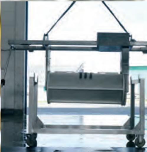
Für Klein- und Massenteile steht eine Trommelbeisanlage zur Verfügung.
