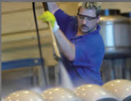
**Beizen** dient der Entfernung aller Verunreinigungen von der Edelstahloberfläche mit dem Ziel, eine metallisch reine Oberfläche zu erhalten. Nur auf solch metallisch reinen Oberflächen kann sich die schützende Passivschicht ausbilden.
