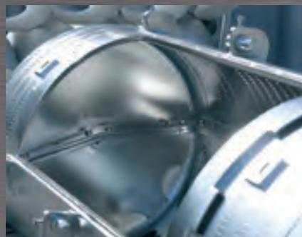
Die Oberfläche einer Edelstahlanlage hat entscheidende Bedeutung durch unmittelbaren Kontakt mit dem Produkt. Elektropolieren verbessert signifikant wesentliche Eigenschaften Ihrer Anlage. Auf elektrochemischem Weg entstehen hochglänzende, nahezu inerte Edelstahloberflächen. Elektropolierte Oberflächen eignen sich außerdem hervorragend für dekorative Zwecke.
