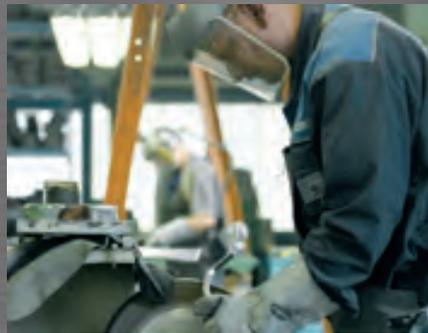
Durch das Schleifen von Edelstahl erzielen wir optisch und funktionell hochwertige Oberflächen von definierter Rauigkeit, wie sie vor allem in der Pharmaindustrie gefordert werden. Für dekorative Zwecke ist auch eine Bearbeitung bis zum Spiegelglanz möglich.
