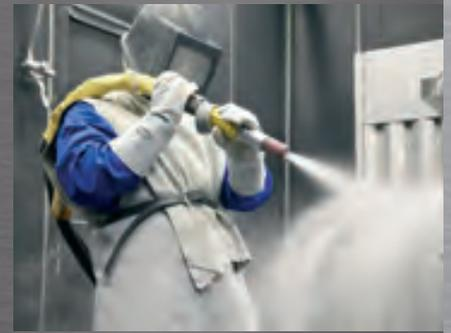
Das Glasperlstrahlen ist eine mechanische Oberflächenbehandlung, die sich hervorragend zur Erzielung einer gleichmäßigen, einheitlichen Optik eignet. Schweißspritzer, Rost, Zunder und Anlauf-farben werden sicher entfernt. Die Oberfläche wird dabei nicht nur gereinigt, sondern auch verdichtet und dadurch die Beständigkeit gegen Spannungs-risskorrosion erhöht. Die glatten und hygienischen Eigenschaften sind vor allem für die Lebensmittel- und chemische Industrie interessant.
