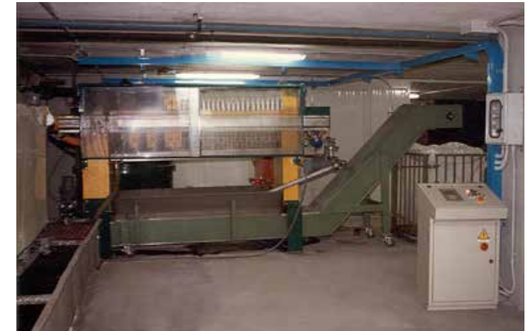
Filtro pressa con nastro trasportatore Filter press with conveyor belt
