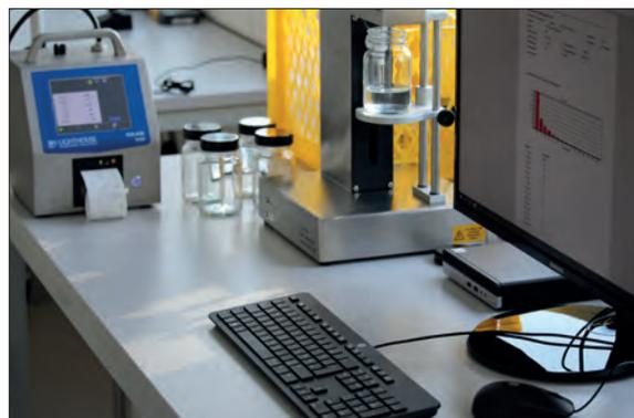
Restschmutzanalysegerät und Partikelmessgerät im Reinraum ISO 8
