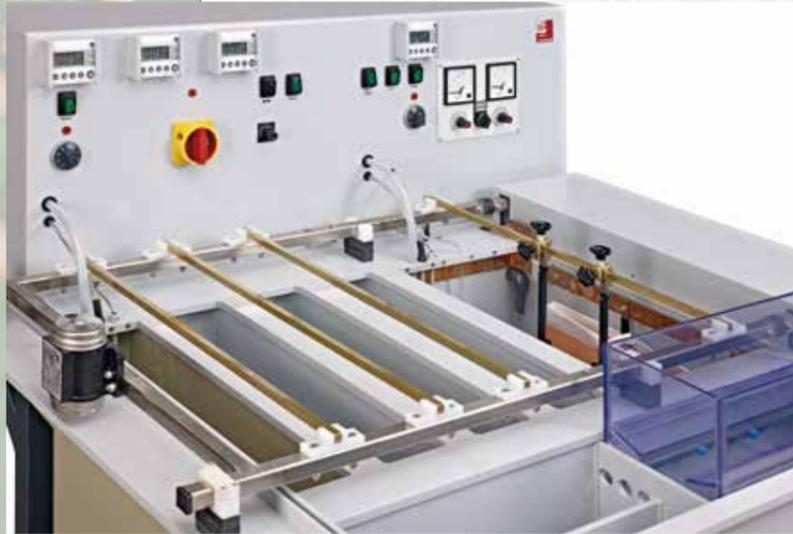
Der modulare Aufbau der Anlagen bietet die Möglichkeit zusätzliche Prozesse ins Anlagenkonzept zu integrieren: Desmear, Blackening, Zinnstripper, Resiststripper, chemisch Zinn, organische Schutzschicht (OSP), chemisch Nickel/Gold, chem. Silber, galvanisch Nickel/Gold. Optimal ausgestattete Behandlungs- und Spülbecken in Kombination mit hochwertigen Einrichtungen und Anlagenkomponenten garantieren ein optimales Leiterplattenergebnis.
