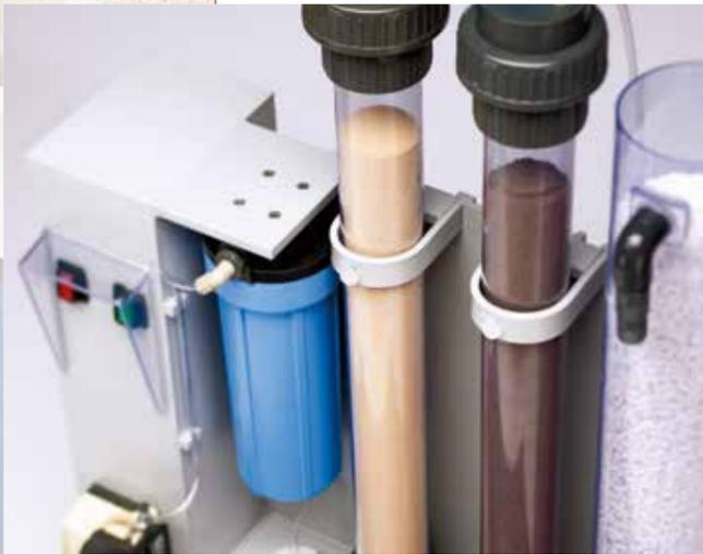
Spezielle Filtertechnologie und Wasseraufbereitung sorgen für ein sauberes Prozesswasser. Neben einer großen Auswahl an Feststofffiltern bieten wir Ionentauschanlagen der Serie IONEX an, die das kontinuierliche Reinigen und Wiederverwenden der Spülwässer aus Spülbädern und Sparspülen ermöglichen. Dies trägt zu einer Erhöhung der Kreislaufwasserqualität und einer wesentlichen Wassereinsparung bei.
