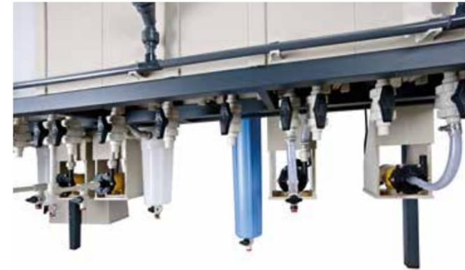
Komplette Filtereinheiten zur Partikel- und Feinfiltration von galvanischen und chemischen Bädern sowie Prozesswasser. Unterschiedliche Ausführungen mit dichtungslosen magnetgekuppelten Kreiselpumpen in PP/PVDF/E-CTFE, geeignet für organische und anorganische Verunreinigungen aus aggressiven und neutralen Flüssigkeiten.
