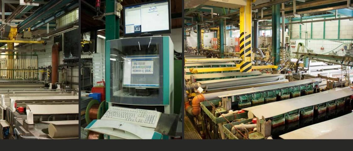
Unser Galvanisierautomat ist mit modernster Steuerungstechnik ausgestattet. Er bietet Ihnen die Beschichtung größerer Stückmengen mit gleichbleibenden Galvanisier- und Abscheidungsparametern. Die Überwachung der Vorgabeparameter erfolgt vollautomatisch.
