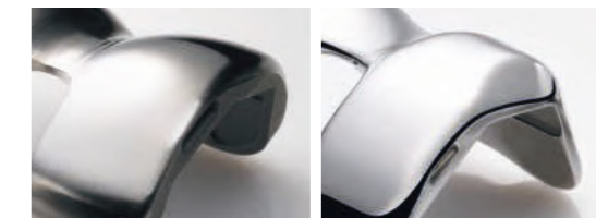
Bsp.: Hochglanzpolierte Oberfläche Ra Wert 0,01 \mu\text{m}
